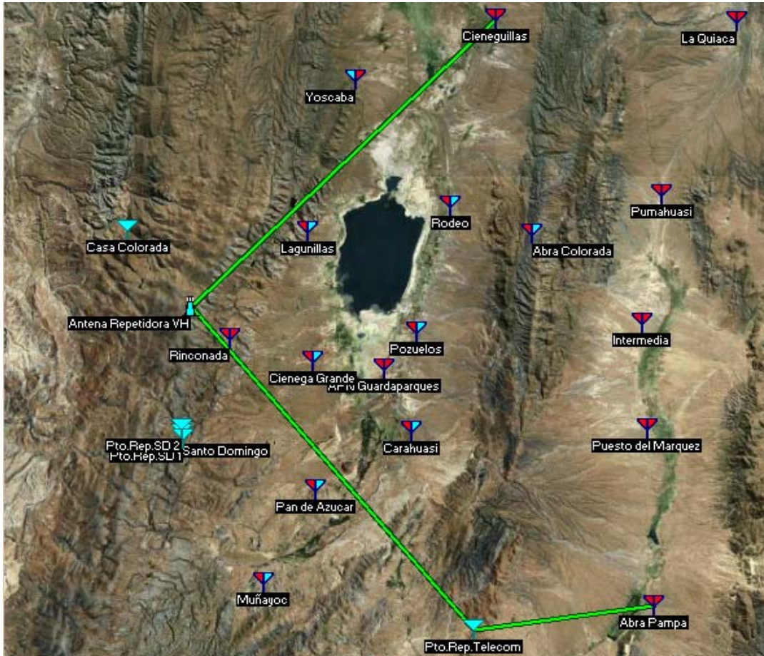
Figura 26: Puntos de acceso a Nodos Red FO REFEFO (AR-SAT) y Radioenlaces a Cerro Rinconada
